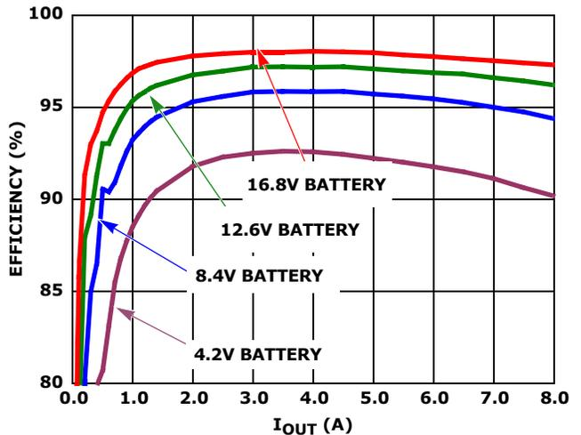
FIGURE 16. EFFICIENCY vs CHARGE CURRENT AND BATTERY VOLTAGE
