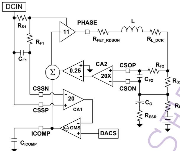
FIGURE 24. ADAPTER CURRENT LIMIT LOOP
